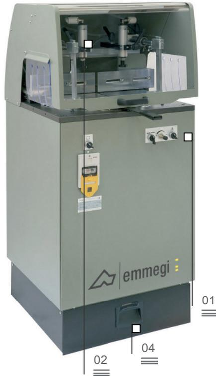
Tronzadora monocabezal ascendente con lado de carga a la izquierda. Sirve para efectuar cortes en angulaciones de 20° (a la izquierda) a 20° (a la derecha) y en angulaciones intermedias. Se encuentra disponible con avance neumático del disco.
